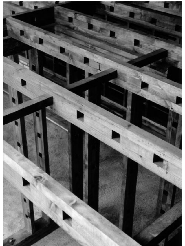
Das Holzbausystem IFA-Norm aus mehrfach verleimten Stützen und Balken im Stecksystem war auch im Masstab 1:10 erhältlich. Ursprünglich als Modellbausatz für interessierte Bauherren gedacht, wurde es unter dem Namen «normi» auch als Kinderspielzeug gehandelt und 1973 an der Internationalen Spielwarenmesse in Nürnberg (D) vorgestellt. – Zeichnung: Auszug aus Verkaufsprospekt der Fa. Joder AG, in Staatsarchiv Uri, Altdorf; PA «Nachlass Josef Furrer-Gisler (1910–1976) / FURAL»; Foto: Privatarhiv Anna Furrer-Gisler
