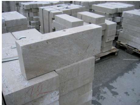
Abbau und Verarbeitung des Natursteines. Die grossen Blöcke wurden mit der Diamantsäge zu Mauersteinen geschnitten.
